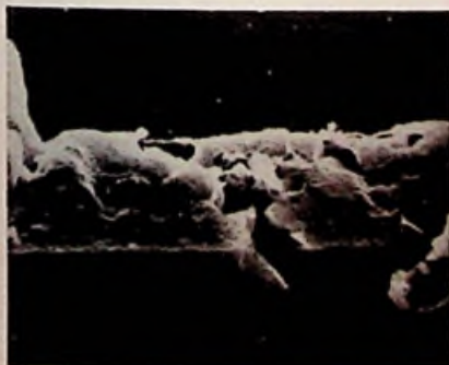
Foto 4 In de aluminiumsporen kunnen onderbrekingen optreden, ten gevolge van elektromigratie. Hiervoor is tijd nodig zodat deze fout zich meestal tijdens het gebruik voordoet.
