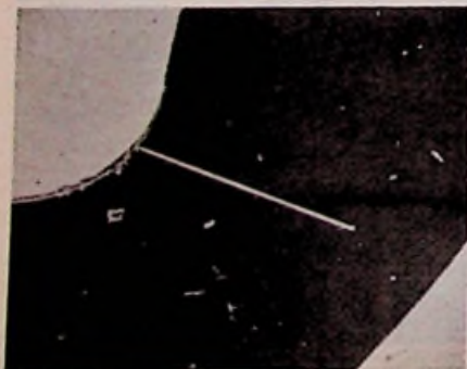
Foto 7 Bij de fabricage van halfgeleiders is het vaak goedkoper om de sporen van puur tin te voorzien. Er kunnen fijne naalden (whiskers) uit het tin groeien waardoor elektrische sluiting ontstaat.
