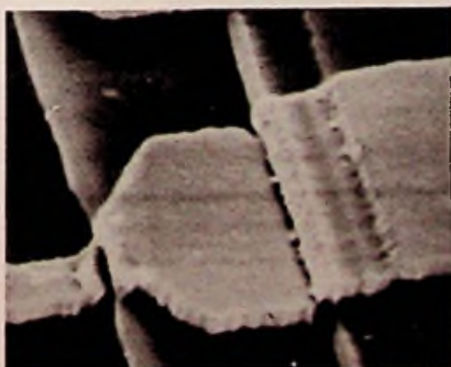
Foto 5 Bij een slechte metallisatie van een siliciumoxydestap is het aluminiumspoor plaatselijk zeer dun. Door elektromigratie kan dan weer een onderbreking ontstaan.
